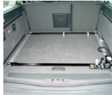
Démontage rapide grâce aux fermetures rapides en cas de besoin d'espace.
